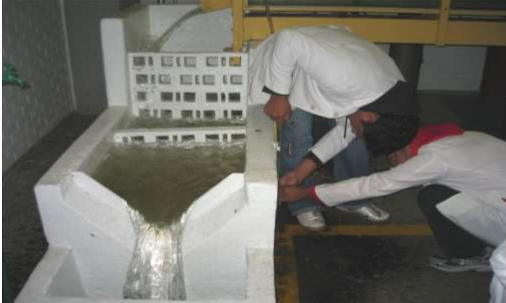
Fotografía 1 Tanqueta con vertedor triangular de pared delgada.
