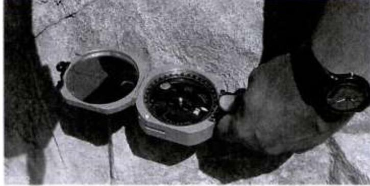
Figura 2. Medición del rumbo
