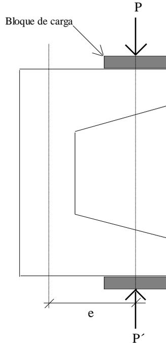
La excentricidad experimental,  $e$ , es la distancia del centroide de la columna al centro de los bloques de carga con asiento esférico.
