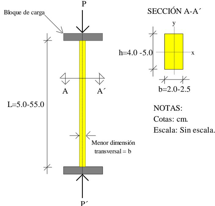
3) Aplique carga lenta y de manera uniforme hasta que se observe una deflexión lateral, en ese momento quite la carga y mueva los extremos ligeramente hacia la parte convexa de la columna y vuelva a cargar. Si la primera carga aplicada que produjo la flexión es mayor que la segunda, entonces la máxima carga columnar será la primera que se obtuvo, en caso contrario repita la operación.
