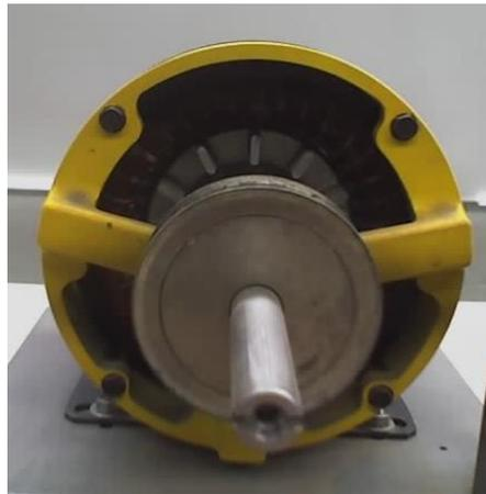
Fig. 9.3 Diagrama físico del motor de inducción
