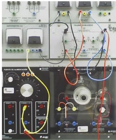
Fig. 6.7b Conexión física para saturación
