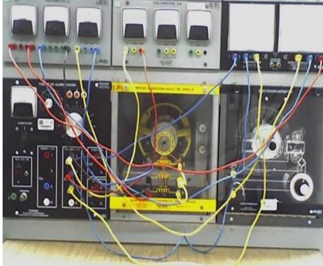
Fig. 9.5b Diagrama físico de conexión del motor Jaula de Ardilla a los módulos de medición (Voltímetro, Amperímetro y Wattímetro).
