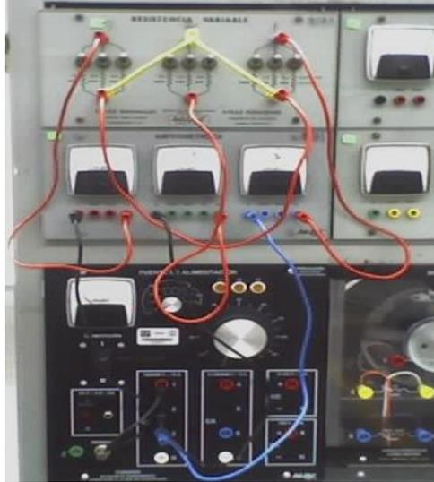
Fig. 6.10b Conexión física de carga conectada en Delta
