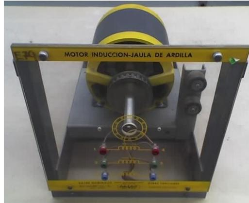
Fig. 9.4 Diagrama físico del motor tipo Jaula de ardilla
