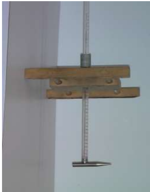
Fotografía 2 Tubo de Pitot 1
