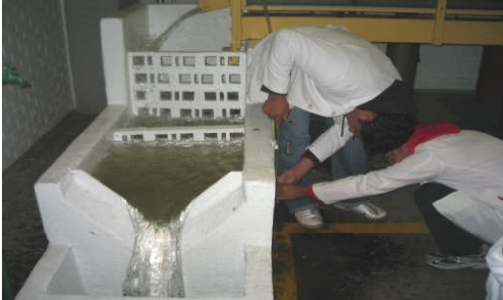
Fotografía 1 Tanqueta con vertedor triangular de pared delgada.
